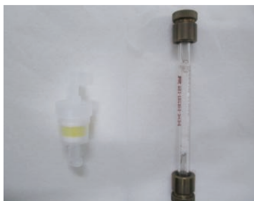
写真-3 捕集管 (左; DNPH カートリッジ、右; Tenax TA ® 吸着管)
