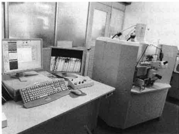
図-2 電子線マイクロアナライザーを用いた硫黄侵入深さ試験の測定状況
