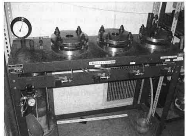
図-5 透水性試験状況
