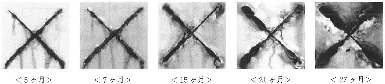
写真5 c-3塗装系 カット部の推移
