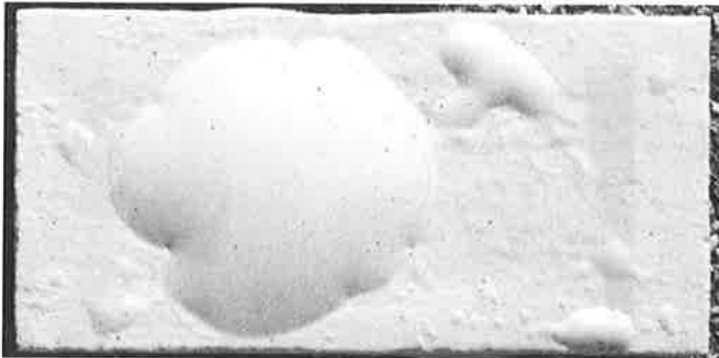
写真 3.1 沖縄 6 年暴露後の代表的な塗膜欠陥（試験体：300 × 150 × 60mm のモルタル板）
