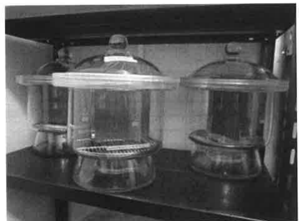
写真2 デシケーター法試験中
