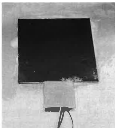
図1 熱流センサー（江藤電気㈱ M55A）
