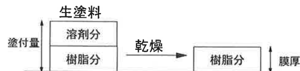
図-1 塗料が乾燥し、塗膜が形成されるイメージ図(顔料分は省略)
